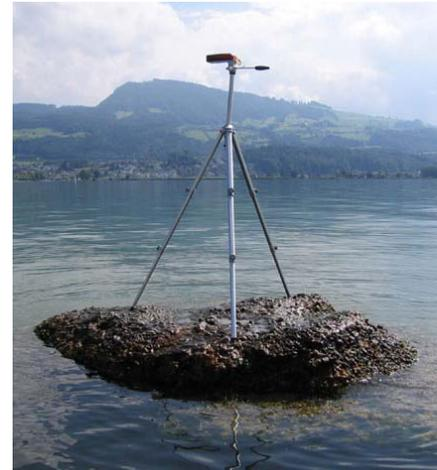
Die Abweichung der beiden gemessenen Schenkellängen, **118.3 m** und **115.5 m**, zu denjenigen eines *gleichschenkligen Vergleichsdreiecks* ist mit je ca. 1.4 m deutlich kleiner als ein typischer Blockdurchmesser. Als Annahme für dieses *gleichschenklige Vergleichsdreieck* dienen ein rechter Winkel bei *Block B* und die gemessene Hypotenuse von **165.4 m**. Die daraus „pythagoräisch“ berechneten Schenkellängen (Katheten) betragen ca. **116.9 m**.
